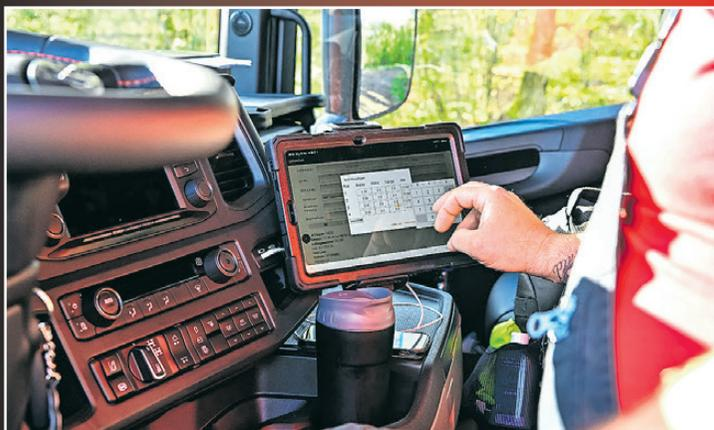
Welche Menge geladen wurde und wie viel im Polter zurückbleibt, wird aus dem Fahrerhaus drahtlos in die Zentrale übermittelt.
