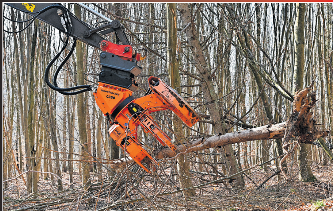
Das allseitig drehbare Anbauwerkzeug ist „Schere“ und Greifer zugleich.
