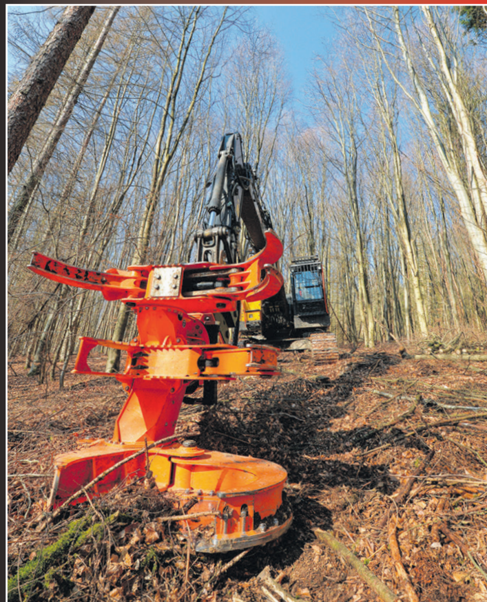
Mit dem Bagger kann Niklas Stämme mit bis zu 40 oder 45 Zentimeter Stärke besonders nah über dem Boden „abknipsen“.
