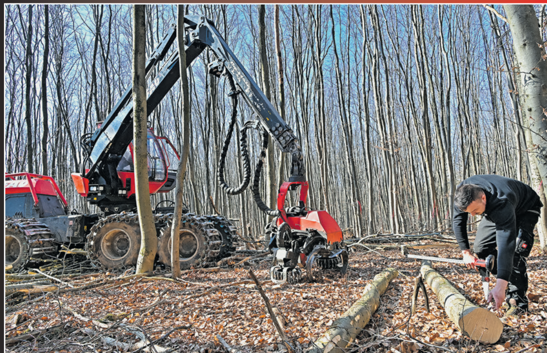
Die Kalibrierung sorgt dafür, dass die Abschnitte exakt so lang sind, wie Ovi es per Steuerung eingegeben hat.
