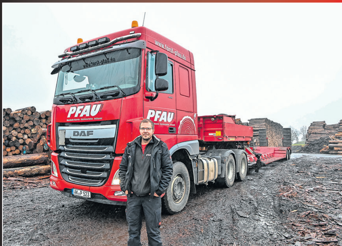
Dieser „DAF 6x4“ war nach der kurzen Episode mit der Kippmulde sein erstes Fahrzeug bei Pfau. „Das einzige bei uns auf dem Hof, dass alle Auflieger ziehen kann und auch darf“, schwärmt „Mudi“. „Es hat sowohl eine Kipperhydraulik für Kippmulden als auch eine Ölpumpe für eine spezielle Lenkung, könnte Langholznachläufer fahren und eben das Tiefbett. Dafür war der DAF hauptsächlich gedacht.“
