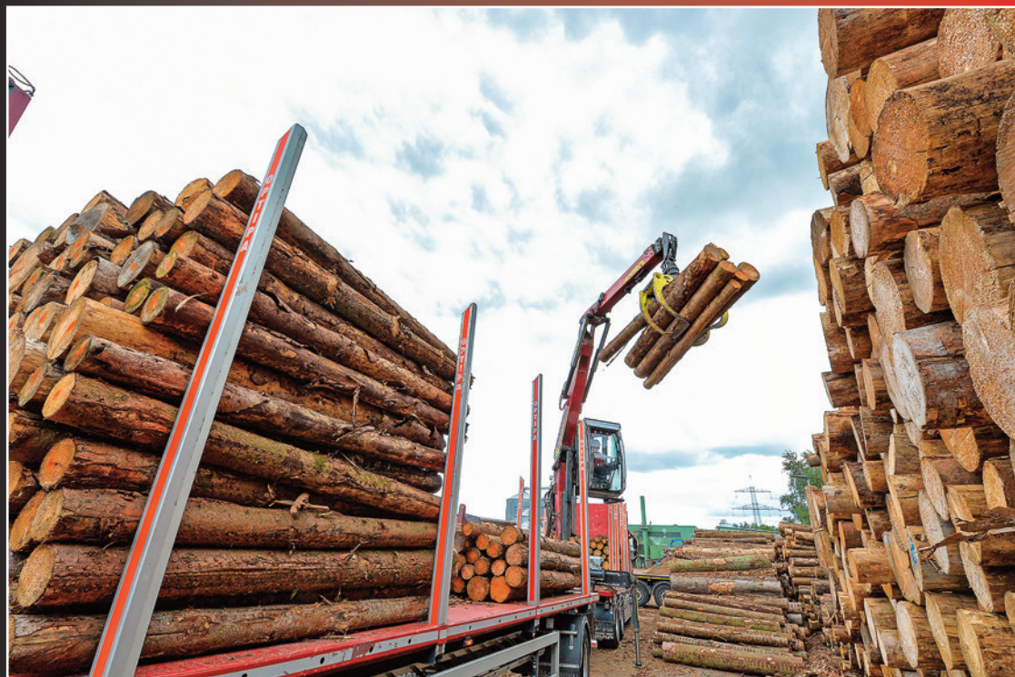
Mit dem Bordkran kann der Kurzholzzug praktisch überall be- und entladen werden, ohne, dass es dazu Um-schlagbagger oder Ähnliches braucht.
