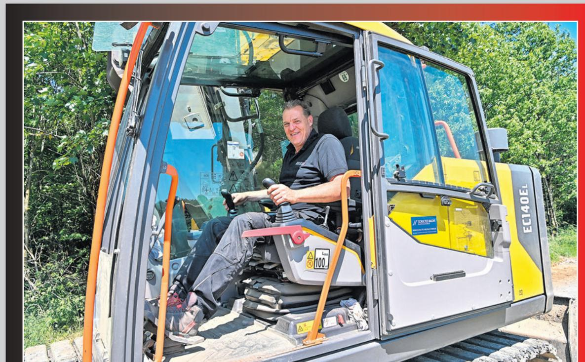
**Über zwei Joysticks hat der Baggerfahrer rund zwei Dutzend Funktionen gleichzeitig „in den Händen“, kann den Hauptarm des Baggers verlängern und verkürzen, den „Stil“ immer näher vor seine Kabine dirigieren oder den Löffel rotieren und dabei zugleich mit den Füßen die Fortbewegung des „ES140E“ steuern – eine sehr komplexe Koordination ist notwendig. „Während du arbeitest, denkst du da nicht drüber nach“, lächelt der Fahrer nur.**
