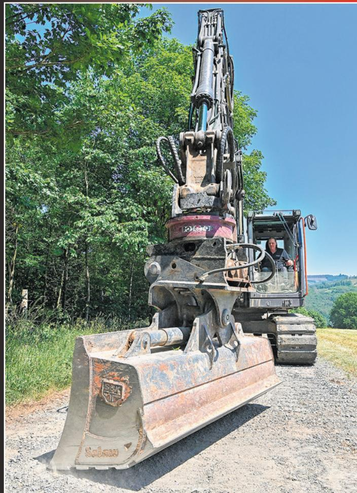
Bei der Arbeit muss Markus Köhler die Baggerbewegungen um etliche Achsen koordinieren, durch einen „Rotator“ kann er den Löffel in alle Richtungen einsetzen.
